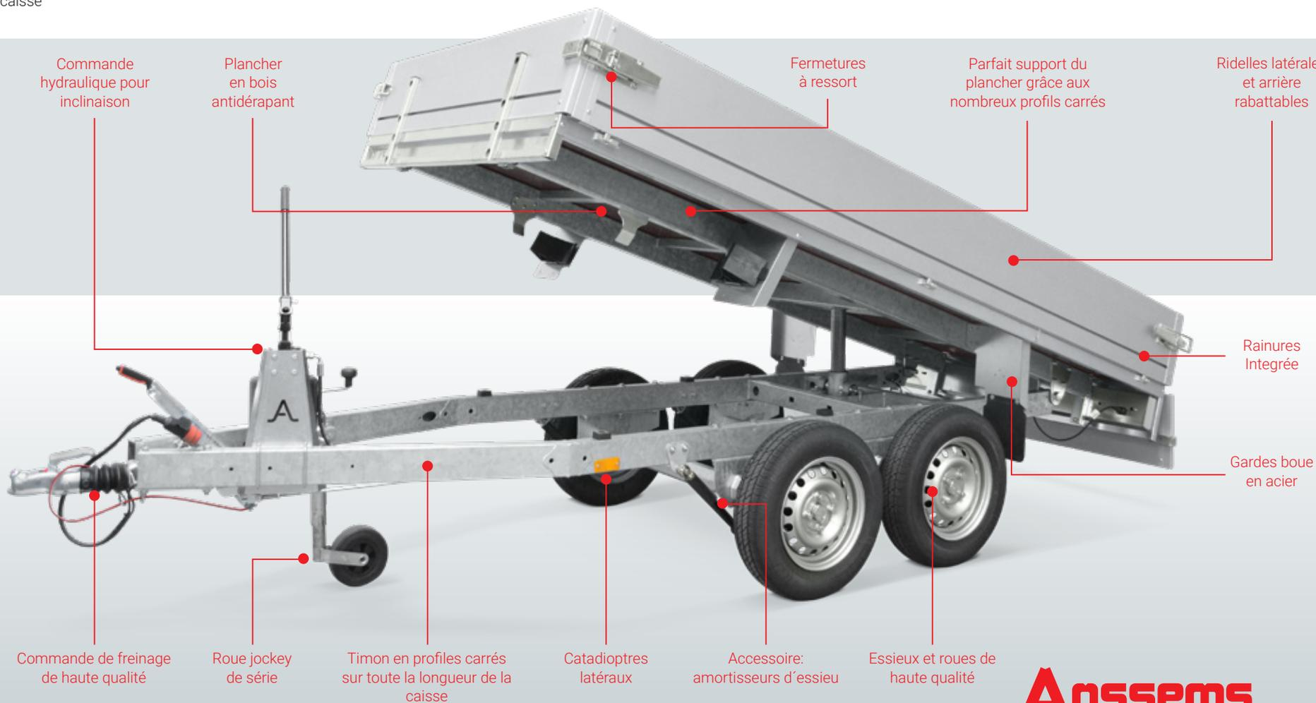
Commande hydraulique pour inclinaison
