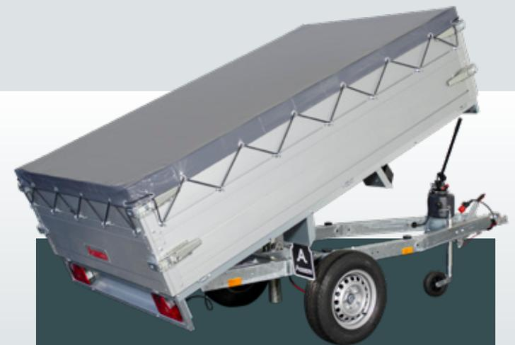
Des ridelles de rehausse de 30cm permettent d'atteindre une hauteur de la caisse de 60cm. La bâche plate est facile à monter, combinée avec les ridelles de rehausse.
