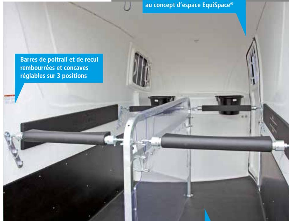
Barres de poitrail et de recul rembourrées et concaves réglables sur 3 positions
