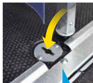
Bat-flanc verrouillable, même lorsque le pont d'embarquement est ouvert
