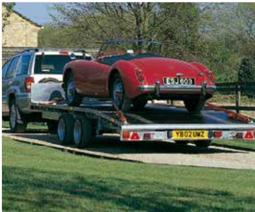
Très proche de la gamme de plateaux, mais avec en plus une section arrière inclinée, ces remorques allient la polyvalence d'un plateau avec l'avantage supplémentaire d'une hauteur de chargement abaissée à l'arrière de la remorque.
