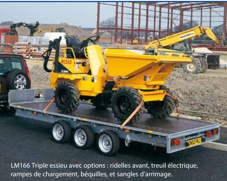
LM166 Triple essieu avec options : ridelles avant, treuil électrique, rampes de chargement, béquilles, et sangles d'arrimage.
