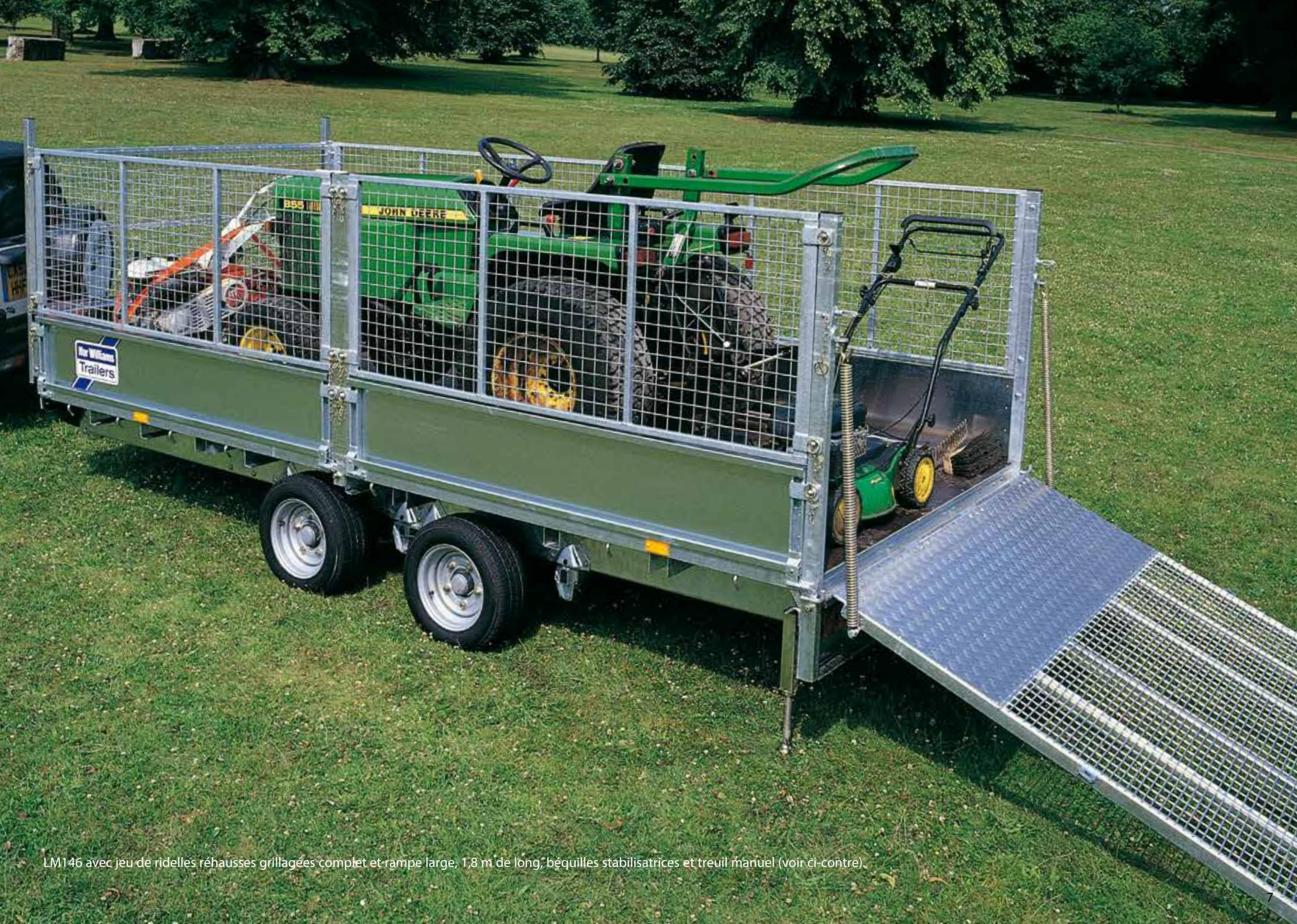
LM146 avec jeu de ridelles réhaussées grillagées complet et rampe large, 1,8 m de long, béquilles stabilisatrices et treuil manuel (voir ci-contre).
