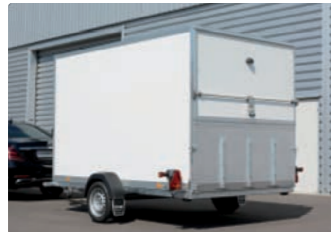
AZSL 1730/176 Geschw. Rahmen verz., Aluprofilheckrampe (Tragkraft: ca. 900 kg, Stärke: ca. 21 mm), Holzboden, Heckklappe m. Drehstangenverschluss V2A AZSL 1730/176 Bâti arrière galvanisé, pont arr. en alu (PTAC : 900 kg env., épaisseur : 21 mm env.), plancher bois, clapet arr. avec serrure standard en inox AZSL 1730/176 Welded, galv. rear frame, alum. rear ramp (PTAC : 900 kg env., thickness: appr. 21 mm), wooden platform, rear hatch w. stainl. steel espagnolette
