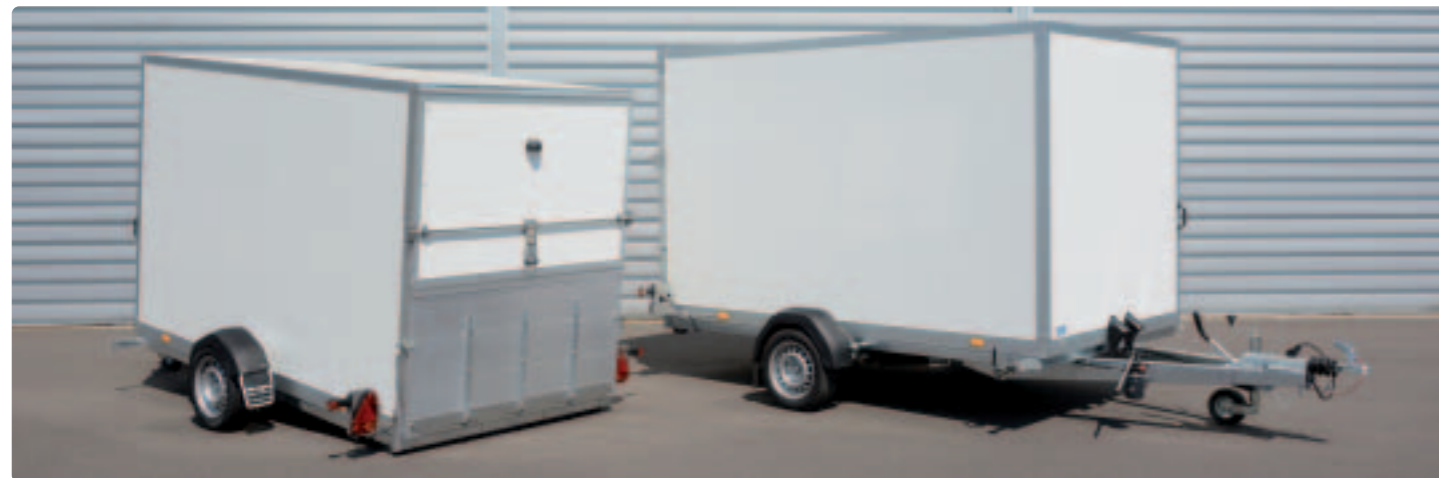
AZSL 1730/151 und AZSL 1730/176 Wände, Heckklappe und Dach (Stärke: 25 mm) aus Sandwichpolyester, Hydraulikhandpumpe AZSL 1730/151 et AZSL 1730/176 Panneaux, clapet arrière et toit (épaisseur : 25 mm) en polyester sandwich, pompe hydraulique manuelle AZSL 1525/151 and AZSL 1730/176 Side panels, rear hatch and roof (thickness: 25 mm) made of sandwich polyester, hydraulic manual pump
