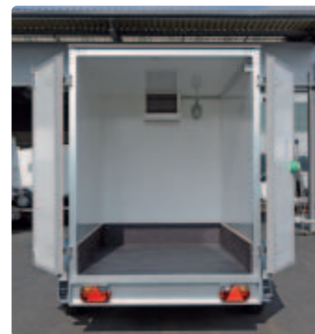
Rammschutz, Innenbeleuchtung 230 V mit Schalter Plinthe, feu intérieur 230 V avec interrupteur Skirting board, interior light 230 V with switch
