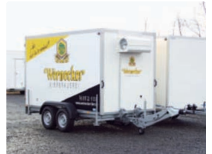
AZKF 2735/180 Sonderkühlung, Zubehör: Deichsel höhenverstellbar AZKF 2735/180 Groupe froid spécial, option : timon réglable en hauteur AZKF 2735/180 Non-standard cooler unit, option: drawbar adjustable in height
