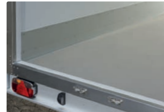
Edelstahlheckrahmen, Kunststoffboden besandet, Aluscheuerleiste Bâti arrière en inox, plancher sablé en polyester, plinthe en alu Stainless steel rear frame, sanded polyester platform, aluminium skirting board
