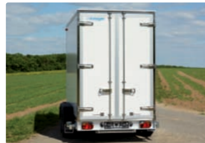
AZK 2730/156 60/60 K Edelstahlchamier / -beschläge, Z.: Trittstufe ausziehbar AZK 2730/156 60/60 K Chamiers / serrures inox, opt. : marchepied extractible AZK 2730/156 60/60 K Stainless-steel hinges / espagnolettes, opt.: pull-out step
