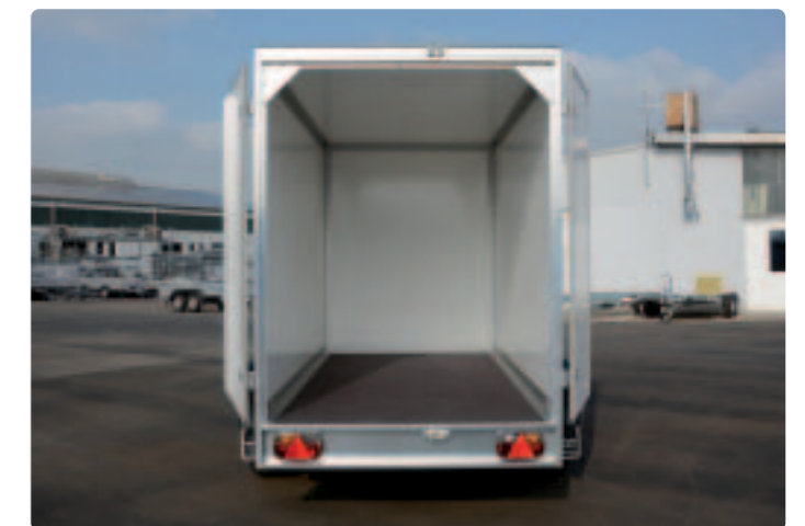
AZ 2030/151 Serie 30 Siebdruckholzboden (18 mm) AZ 2030/151 Serie 30 Plancher en bois antidérapant imperméabilisé (18 mm) AZ 2030/151 Series 30 High-density plywood platform (18 mm)
