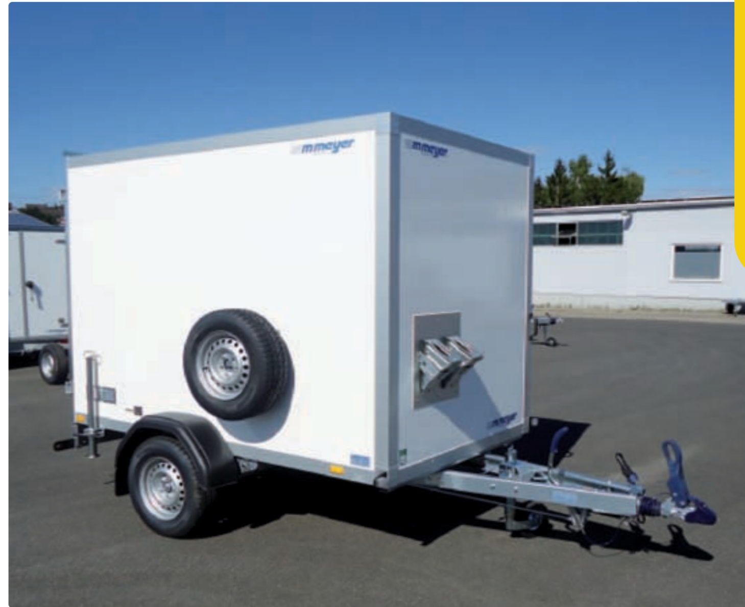
AZ 1325/151 Serie 70 Zubehör: u. a. Antischlingerkupplung, Stützradtraverse, Lüftungslamelle, Unterlegkeile (Stahlblech), Ersatzrad AZ 1325/151 Série 70 Options : stabilisateur pour tête d'attelage, traverse pour roue jockey, aération, cales de roue (tôle d'acier), roue de secours, etc. AZ 1325/151 Series 70 Optional extras: anti-sway coupling, jockey wheel support, ventilation vent, steel wheel chocks, spare wheel, etc.
