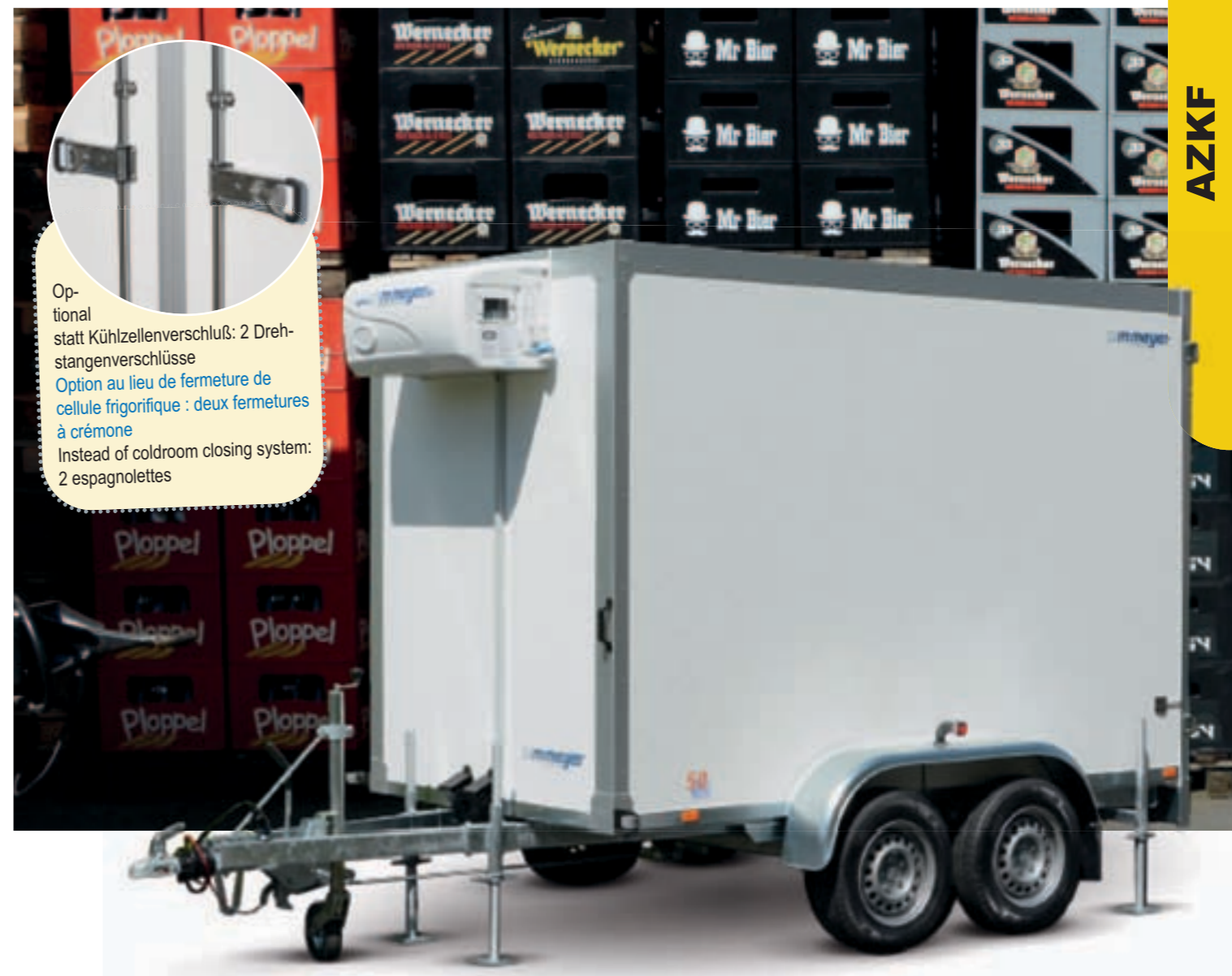
AZKF 2730/155 Stützrad verstärkt, 4 Schwerlaststützen, Aufbau Sandwichpolyester, Kühlmaschine WMK 4 AZKF 2730/155 Roue jockey renforcée, 4 béquilles renforcées, panneaux, porte et toit en polyester sandwich, groupe froid WMK 4 AZKF 2730/155 Reinforced jockey wheel, 4 reinforced prop stands, side panels, door and roof made of sandwich polyester, cooler unit WMK 4
