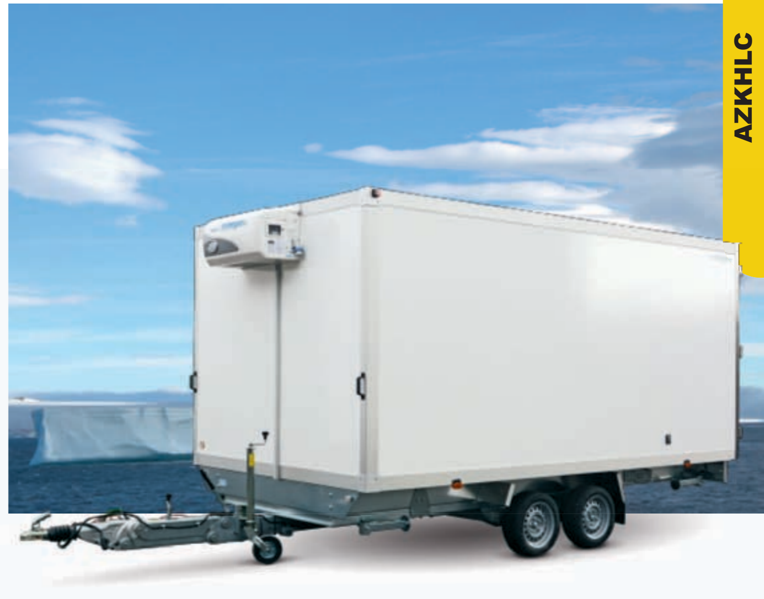
AZKHLC 3544/203 60/60 K Sonderkühlkofferanhänger Kühlung WMK 7, Zubehör: höhenverstellbare Deichsel, Klappkurbelstützen AZKHLC 3544/203 60/60 K Fourgon spécial frigorifique Groupe froid WMK 7, options : timon réglable en hauteur, béquilles à relever (avec manivelle) AZKHLC 3544/203 60/60 K Special chiller box van Cooler unit WMK 7, optional: drawbar adjustable in height, prop stands to be folded away (with crank)
