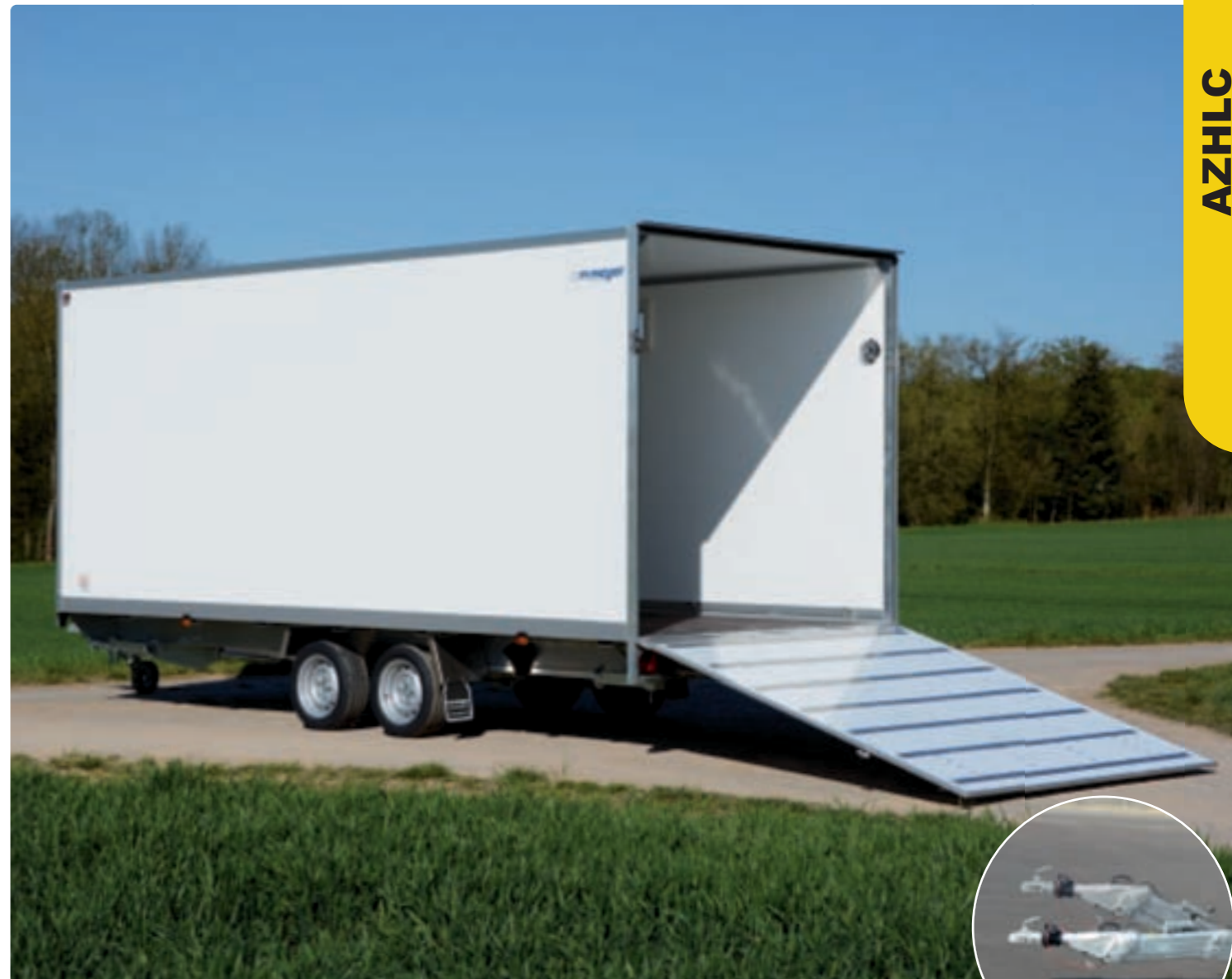
AZHLC 2750/210 Zubehör: u. a. Klappkurbelstützen, Heckrampe mit Hebedämpfern; rechts: Deichsel höhenverstellbar AZHLC 2750/210 Options : béquilles à relever avec manivelle, pont arrière avec vérins, etc. ; à droite : timon réglable en hauteur AZHLC 2750/210 Optional extras: prop stands to be folded away, with crank, ramp with shock absorbers, etc.; right: drawbar adjustable in height
