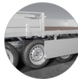
A partir de 5m les ridelles latérales sont composées de deux parties
