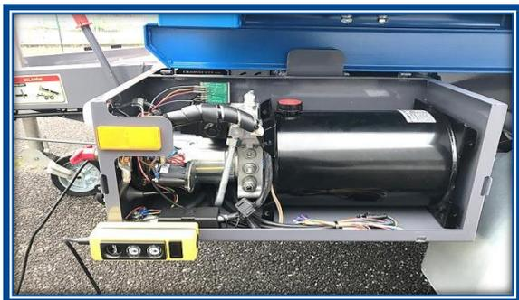
La batterie 12V de 154 Ah alimente en énergie la centrale électrohydraulique ce qui permet un fonctionnement autonome du bras.
