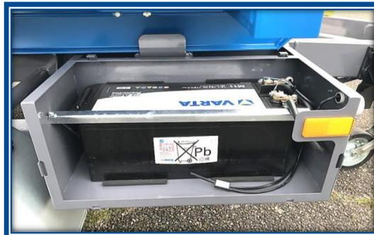
La batterie peut être rechargée soit par l'alimentation du véhicule tracteur, soit à l'aide du chargeur 12V connecté sur une prise 220V.
