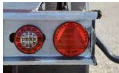
Systèmes de freinage et d'éclairage multitension (en option), 12 - 24 V chacun
