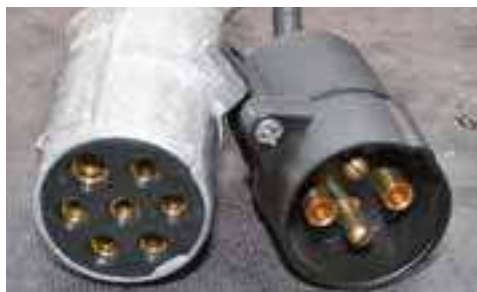
1 connecteur 7 pôles et 1 connecteur 4 pôles, y compris câbles de connexion
