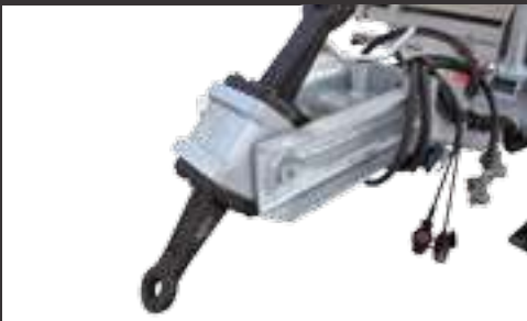
Barre d'attelage avec tête pivotante (Ø 40/50 mm)
