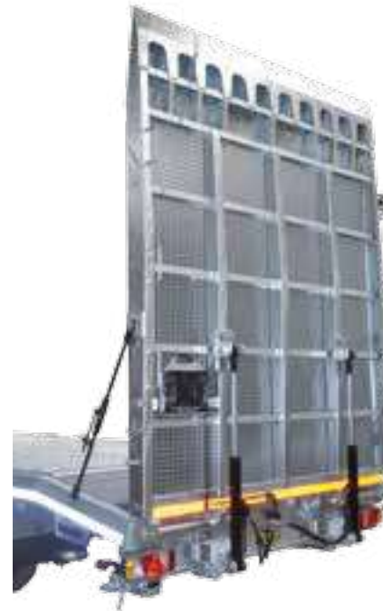
Pont arrière hydraulique avec caillebotis en acier
