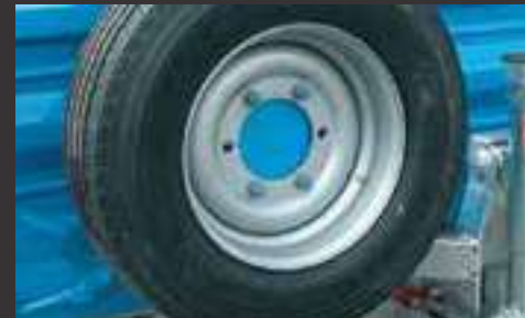
Support de roue de secours sur la ridelle frontale (uniquement pour ridelle en acier)
