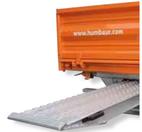
2 rampes d'aluminium insérables sous la surface de chargement
