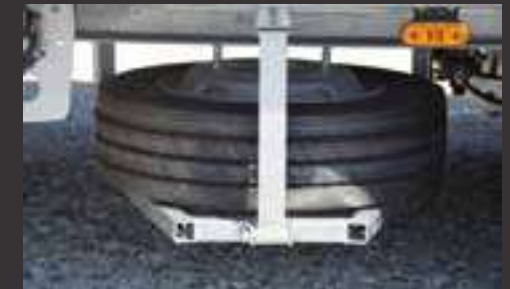
Support de roue de secours comme panier sous la surface de chargement
