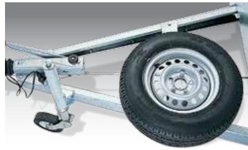
Roue de secours montée sur timon
