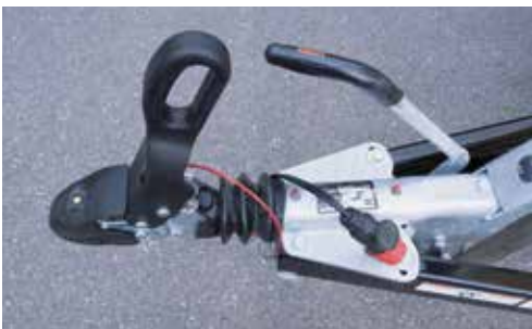
Attelage sécurisé avec stabilisation de voie
