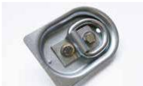
Anneaux de fixation encastrés montés dans le plancher de bois, force de traction par anneau 0,4 t (4 ou 6 pièces)
