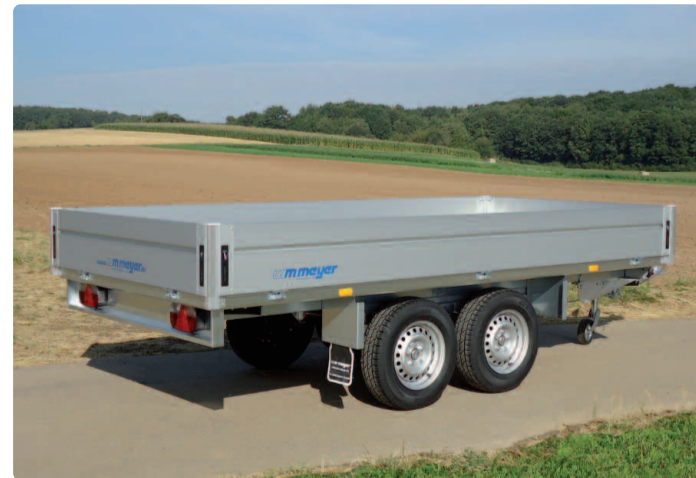
HLN 2536/170 Stützrad verstärkt (klappbar, mittig) HLN 2536/170 Roue jockey renforcée (automatique, au milieu) HLN 2536/170 Reinforced jockey wheel (automatic, in the middle of the drawbar)
