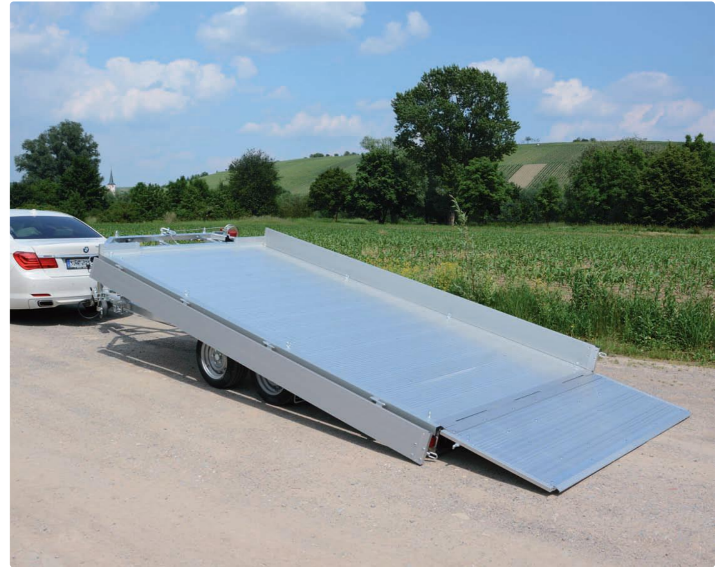
MKHL 2700 Aluprofilboden geschlossen, Auffahrrampe (Höhe: ca. 600 mm), Bordwände seitlich 200 mm hoch und klappbar; Zubehör: Winde MKHL 2700 Plancher intégral en profilés d'aluminium, rampe en alu (hauteur : 600 mm environ), ridelles latérales rabattables (hauteur : 200 mm) ; option : treuil MKHL 2700 Closed aluminium platform, aluminium ramp (height: approximately 600 mm), fold-away side panels right / left (height: 200 mm); optional extra: winch
