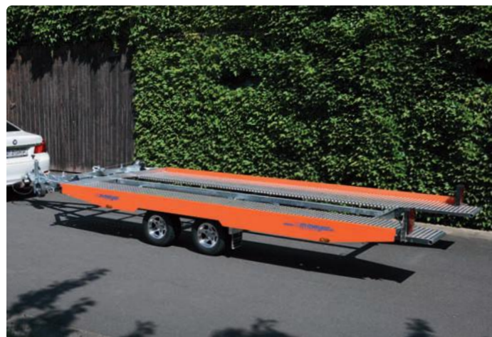
KHL 3000 Autotransporter (kippar, Hochlader) KHL 3000 Porte-voiture (basculante, remorque plateau) KHL 3000 Car transporter (tipper, highrider)
