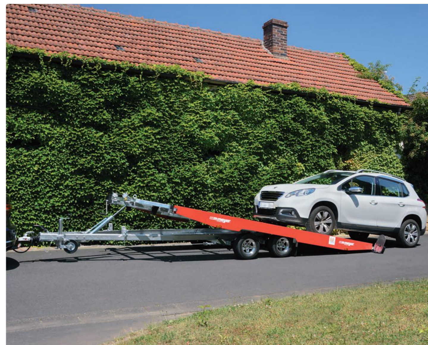
KHL 2700 Red and Restless 2 Alustandschienen mit 16-Lochbild für Radsicherung, maximaler Radstand des transportierten Fahrzeugs: 3,15 m KHL 2700 Red and Restless 2 rampes en alu avec 16 trous d'arrimage pour sangles à cliquer, empattement maximal du véhicule transporté : 3,15 m KHL 2700 Red and Restless 2 fixed aluminium ramps with 16 fastening holes for straps, maximum wheelbase of transported vehicle: 3.15 m
