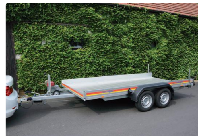
AP 2740/200 Alubordwände (Höhe: 200 mm) AP 2740/200 Ridelles en alu (hauteur : 200 mm) AP 2740/200 Aluminium panels (height: 200 mm)
