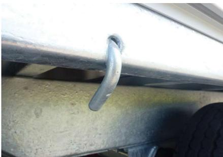
8 crochets sur le bord du châssis, fortement soudées à l'intérieur.
