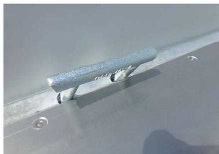
8 anneaux d'arrimages intégrés dans le sol, 2,5 tonnes
